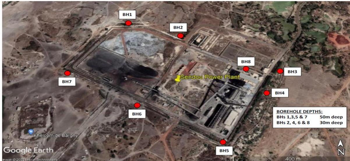
Photo 2. Emplacement des forages pour la surveillance des eaux souterraines. Source : Sebenzana, septembre 2022.
